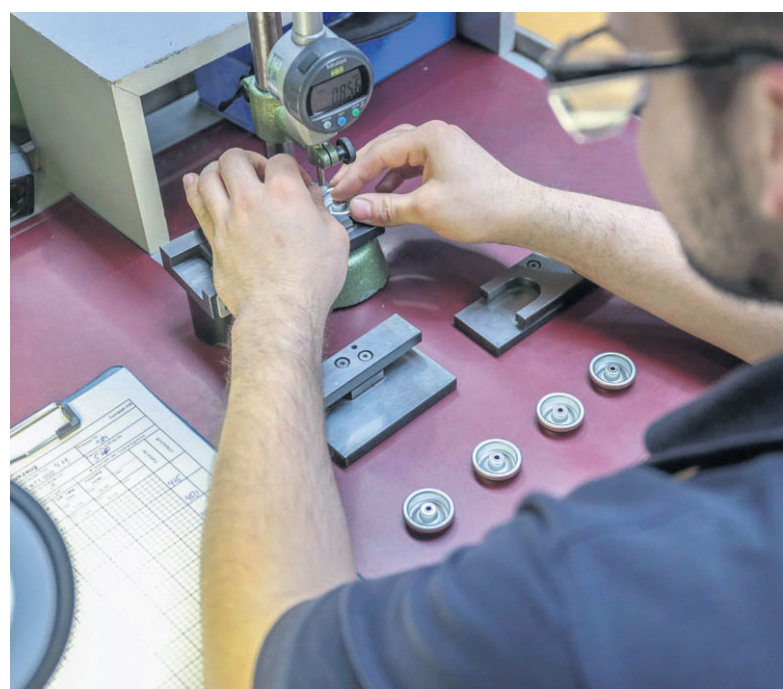
Präzision ist bei den Ventiltellern sehr wichtig. An jeder Stanzanlage kontrolliert der Maschinenführer stichpunktartig die richtigen Maße.
