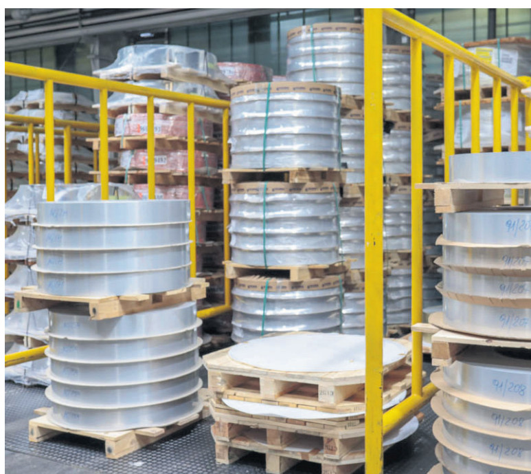
Das Weißblech oder Aluminium, aus denen die Ventilteller gestanzt werden, werden in sogenannten Coils angeliefert, riesige Rollen.
