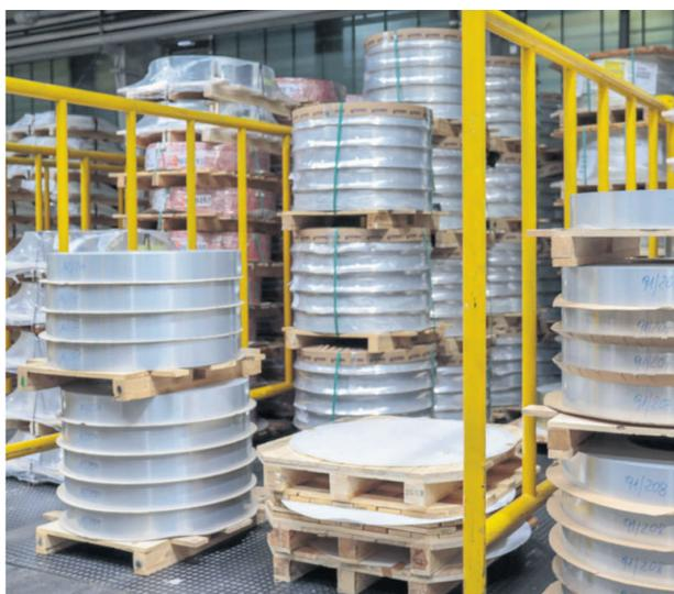
Das Weißblech oder Aluminium, aus denen die Ventilteller gestanzt werden, werden in sogenannten Coils angeliefert, riesige Rollen.
